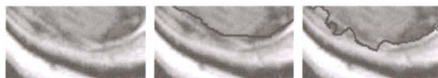
Figura 7. A imagem da esquerda mostra a imagem original, a do meio o esboço inicial e a da direita apresenta o resultado da GVF snake , sem mais interação.
