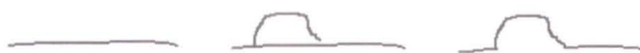
Figura 10. Exemplo de substituição de parte de um contorno por um novo esboço.
